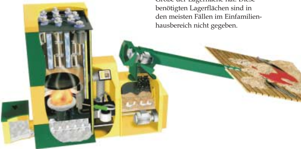
Prinzipschema einer Hackschnitzelfeuerung
